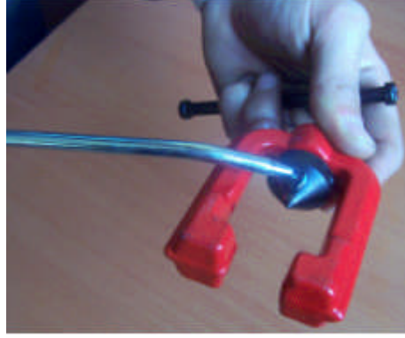
Resim 4.3 : Havşa konisinin yağlanması
