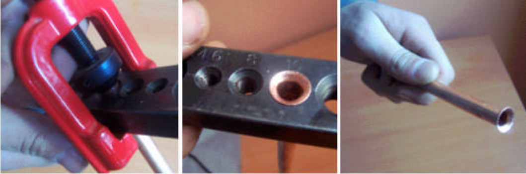
Resim 4.4 : Havşa takımı kullanarak havşa açma
