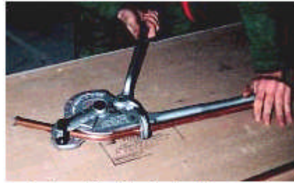
Resim 5.3 : Manivela tipi aparatla bakır boru bükümü
