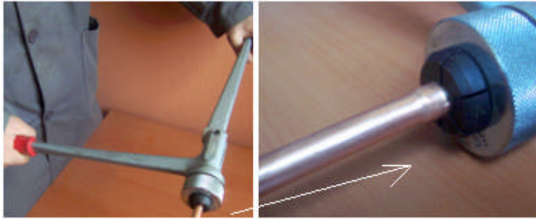
Resim 3.11 : Muf açma aparatı ile muf açma
