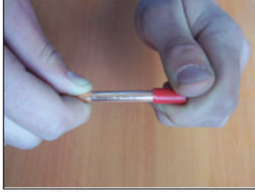
Resim 2.7 : Borunun tapa ile kapatılması
