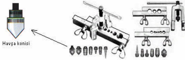
Resim 4.1 : Yumuşak çekilmiş bakır borulara havşa ve muf açmada kullanılan takımlar
