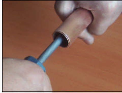
Resim 2.3 : Yuvarlak eęe ile apak alma
