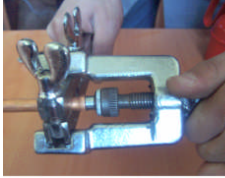
Resim 3.10 : Havşa aparatı ile muf açma
