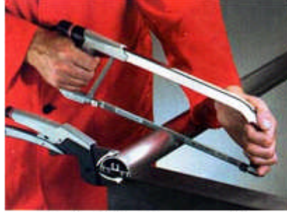
Resim 1.11 : El testeresi ile bakır boru kesme işlemi
