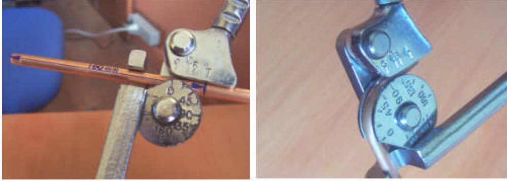
Resim 5.7 : İş parçasının bükme aparatına yerleştirilmesi ve bükülmesi
