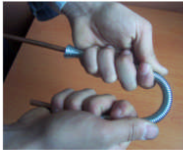
Resim 5.8 : Bakır borunun bükme yayısı ile bükülmesi
