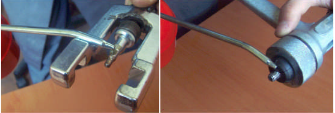
Resim 3.4 : Havşa takımında zımbanın yağlanması
