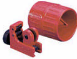
Resim 2.1 : Rayba ve mini bakır boru makası
