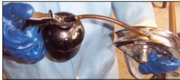
Resim 5.6 : Bükme aparatının tekerlek kanallarının yağlanması
