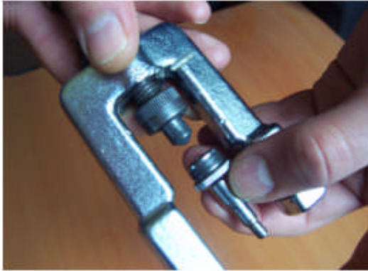
Resim 3.8 : Zımbanın havşa aparatına takılması
