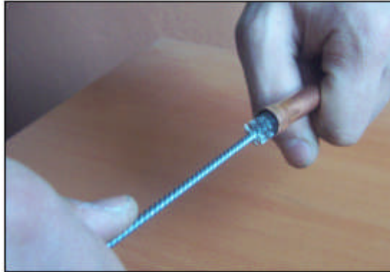
Resim 2.4 : Tel fıra ile boru temizlięi
