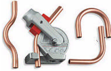
Resim 5.4 : Manivela ile bükülmüş bakır borulara örnekler
